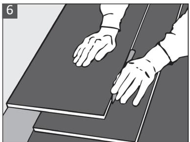
**6** Einpassen der letzten Dielenreihe: Legen Sie exakt auf die zuletzt verlegte Dielenreihe die nachzusägende Diele. Dann zeichnen Sie mit Hilfe einer weiteren Diele den Längsschnitt an. Durch diese Art des Anzeichnens bleibt genügend Abstand zur Wand um die letzte Reihe mittels Zugeisen einzuwinkeln.
