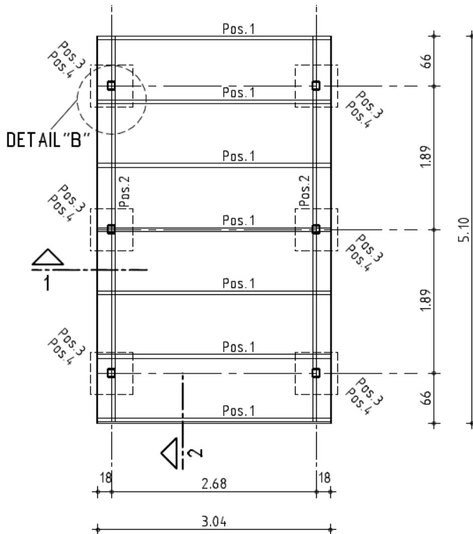
Legen Sie die Sparren auf die Tragbalken und befestigen Sie diese wechselseitig mit den HVV Winkeln, die Sie wiederum mit den beiliegenden Spax-Schrauben 4x30 mm befestigen (siehe Skizze Nr. 2).
